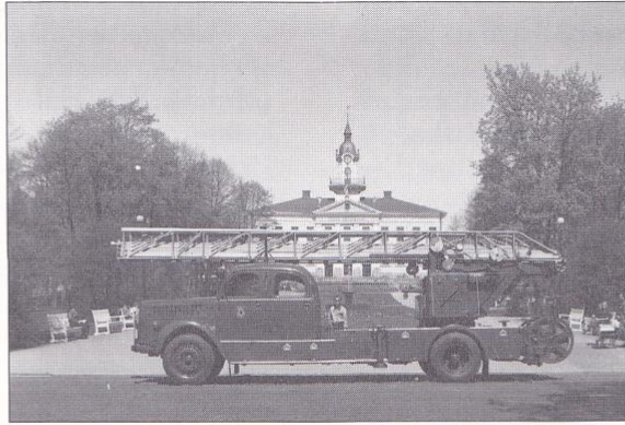
41. - 43. Kohti huikeita korkeuksia. Palolaitoksen konetikapuuauto Scania-Vabis vm. 1952. Tikkaiden korkeus 30 metriä.
